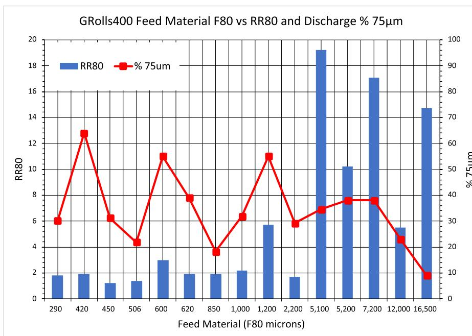
**Fig. 12.** GRolls® F80 vs RR80 and % 75  $\mu\text{m}$ .
